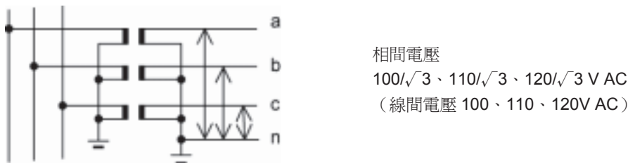
圖 1-2 相間電壓輸入(在設定代碼 04 處選擇設定值「2」)
