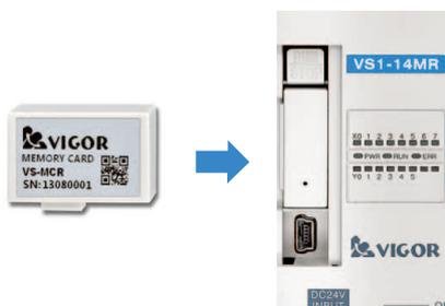
多功能記憶卡採用Flash ROM記憶體，具有免電池停電保持的特性。記憶卡就像PLC的硬碟一般，可儲存VS系列專案及655,360個Words大容量資料。
