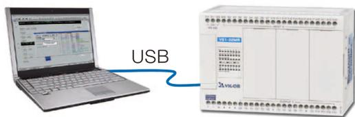
通訊速率高達12Mbps，徹底解決長久以來PLC與編程軟體間專案寫入/讀出及監看反應速度太慢的問題。16K Words專案寫入或讀出約只需3秒鐘，大大提高工作效率。監看反應速度大幅提升，看得更即時，看得更清楚，有效提高監控設備的品質。
