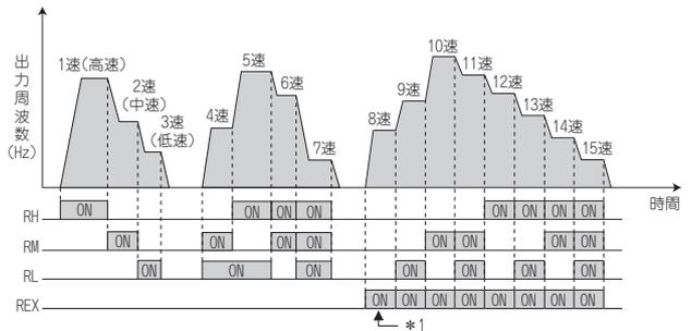
\*1 Pr.232 多段速設定(8速) = "9999" 設定時、RH, RM, RLをOFF、REXをONとするとPr.6の周波数で動作します。
