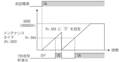
● インバータの累積通電時間を1h毎にEEPROMに記憶し、*Pr.503* メンテナンスタイマに100h単位で表示します。*Pr.503* は、9998 (999800h) でクランプされます。
