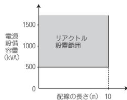
また、単相100V電源入力仕様品に電源トランス(容量50kVAを超える)を接続した場合、信頼性の向上のためにACリアクトル(FR-HAL)を設置してください。
