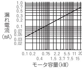
CVケーブルを金属管配線した場合の商用電源運転時の1kmあたりの漏れ電流例 (3相3線式△結線400V60Hz)
