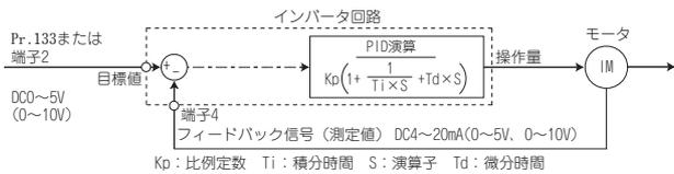
●ダンサロールの位置検出をフィードバックしてPID制御を行い、ダンサロールが指定位置となるように制御できます。Pr.128 PID動作選択を40~43に設定することでダンサ制御を行います。主速指令は各運転モード (外部、PU、通信) の周波数指令となります。ダンサロールの位置検出信号よりPID制御を行い、主速指令に加算します。
